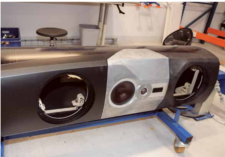
Die Chassis der Mittel-/Hochtoneinheit stecken in einem massiven Alublock.
